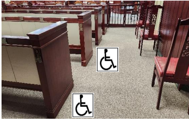
圖六、憲法法庭旁聽席目前無常設的無障礙席位，惟旁聽席位通道尚屬寬敞，堪容輪椅旁聽席位(90 公分*150 公分)加設於側方，不妨礙通行。
