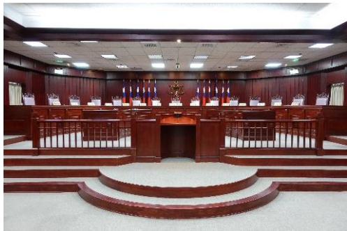
圖九、憲法法庭的中央發言台前有二階台階，影響法庭設施對於輪椅使用者的可及性。
